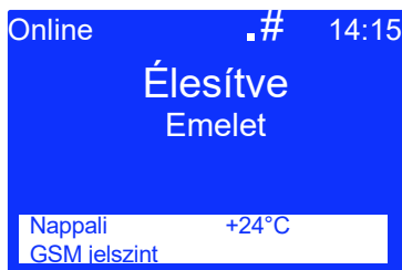
A kijelzőn ~ 5 mp.-ként felváltva megjelenik az élesített és az élesíthető partíció neve.
